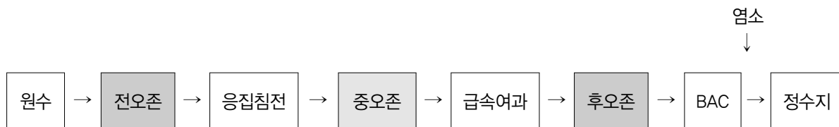
<그림 9.6> 일반적인 오존주입지점 및 공정도
