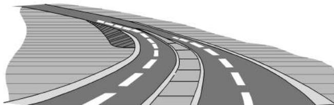
**그림 5-66** 평면선형과 종단곡선의 균형**(3) 노면 배수 및 자동차의 역학적 요구에 적절히 조화된 경사가 설치될 수 있도록 조합할 것.**
