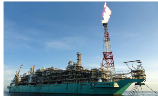
부유식 LNG 생산설비 (FLNG : Floating LNG)
