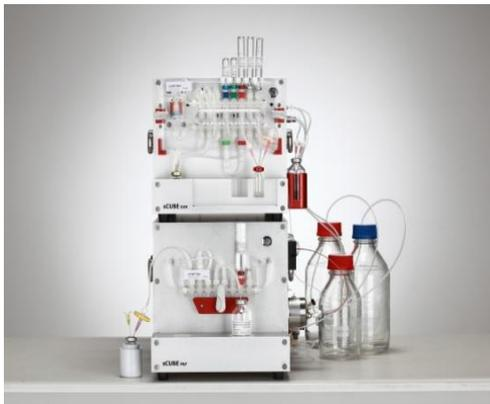
**\* 자동합성장치: 차폐된 공간에서 방사성의 약품을 원격으로 합성 정제 제제 등의 생산 프로세스를 통해 GMP수준의 의약품을 대량으로 생산하는 하드웨어 시스템**
